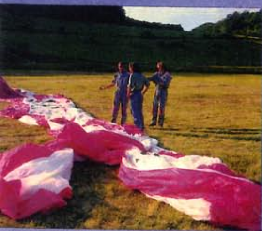
Die Luftschiffhülle wird ausgelegt
