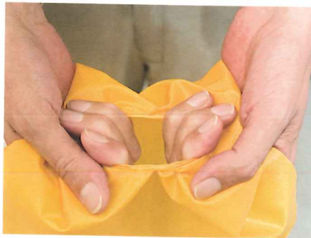
Die vorgesehene Außenhülle eines Luftschiffs muss auf Reißfestigkeit überprüft werden.
